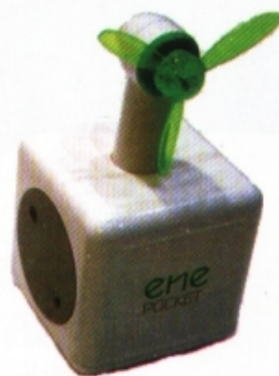
Prototypová bio baterie napájející ventilátorek
