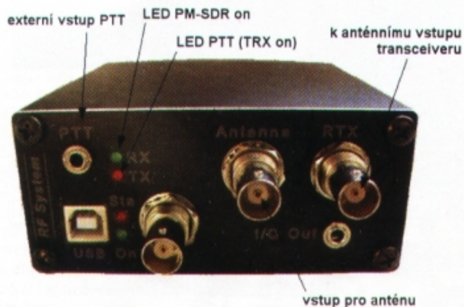
Obr. 3. Přijímač PM-SDR ve skříňce s vestavěným přepínačem antény
